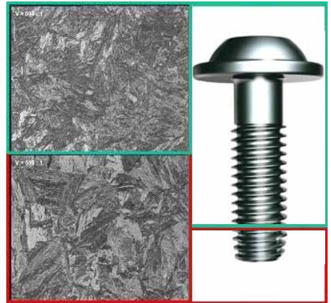
Gefügeaufbau bei EJOT® HardTip Schrauben
