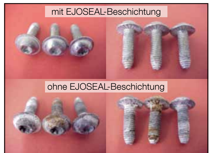
Korrosion nach 288 h Testdauer nach DIN EN ISO 9227-NSS (Überzugssystem: galvanisch verzinkt 8µm, blau passiviert + EJOSEAL)
