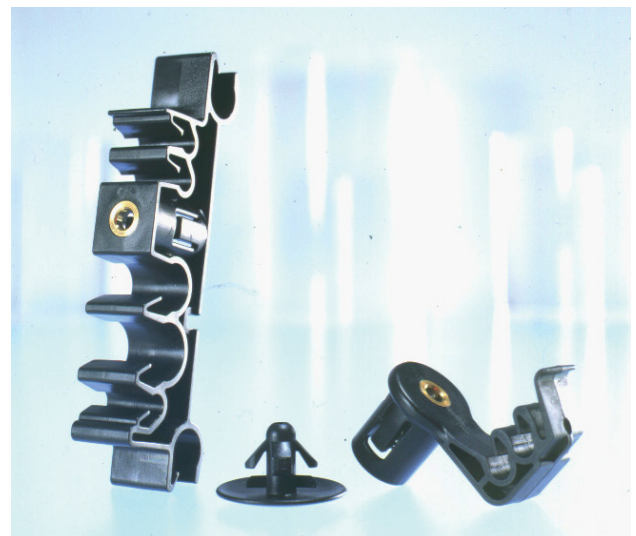
Anwendungsbeispiel: Befestigung der Brems- (Ø 4,75mm) und Kraftstoffleitungen (Ø 8-10mm) am Fahrzeugunterboden des Opel Astra
